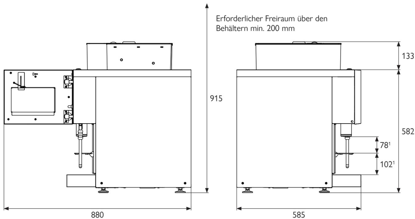
Die Melitta® Cafina® CT4 wird anschlussfertig geliefert. Vor dem Aufstellen müssen jedoch die bauseits notwendigen Anschlüsse gut zugänglich innerhalb eines Radius von 1 m installiert sein. Diese Vorarbeiten müssen von konzessionierten Fachleuten unter Beachtung der gültigen Vorschriften ausgeführt werden. Der Melitta® Kundendienst ist hierzu nicht berechtigt und übernimmt keinerlei Verantwortung für die Installation.
